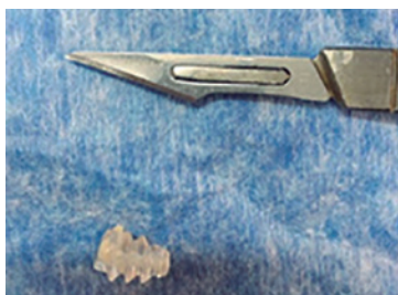
Fig. 4 Imagen de fragmento roto de tornillo tibial biodegradable.
