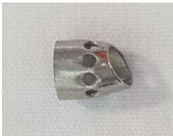
Figura 5. Extremo distal de la cánula. Se observan los bordes netos en la zona de fatiga.
