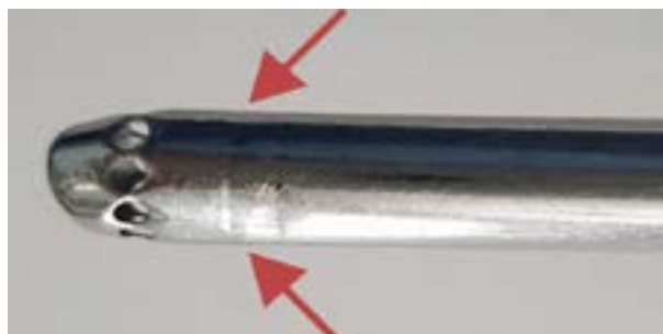
Figura 3. Extremo distal de la cánula. Se aprecia la zona de unión por soldadura (flechas)
